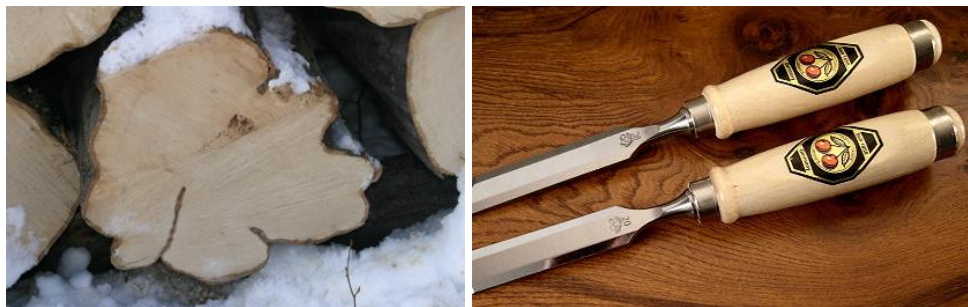
4. ábra Bordás gyertyántörzs (bal) és gyertyánból készült vésőnyél (jobb) (forrás: fahiba.fmk.nyme.hu/18_bordas%20noves.htm , fine-tools.com/schraegbeitel.html )
