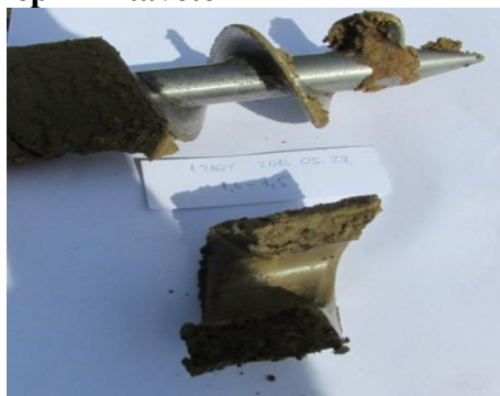
5. ábra. csigafúróval történt mintavétel
