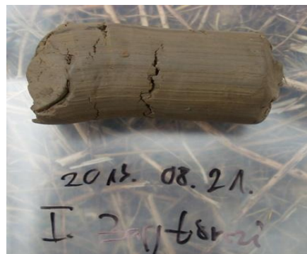
6. ábra. csővel történt mintavétel
